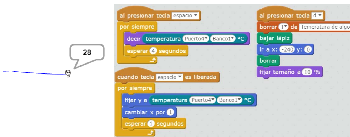
Fig. 4: Programación del sensor para mostrar la gráfica de la temperatura
