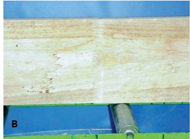
Figura 1 - 92: A) Pieza de Pino radiata en que se ha eliminado nudo, se somete al proceso de confección de los dedos para la unión. B) Unión de las piezas, logrando continuidad de la pieza.
