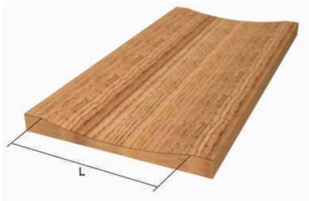
Figura 1 - 57: Depresión por cepillado.
