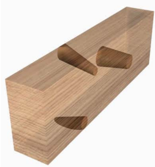
Figura 1 - 67: Proyección del nudo en la sección interior de la pieza.
