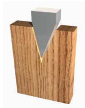
Figura 1 - 36: Esquema de ensayo de clivaje. Dependiendo de la ubicación de los anillos de crecimiento con respecto al plano de falla, el clivaje puede ser tangencial y radial.
