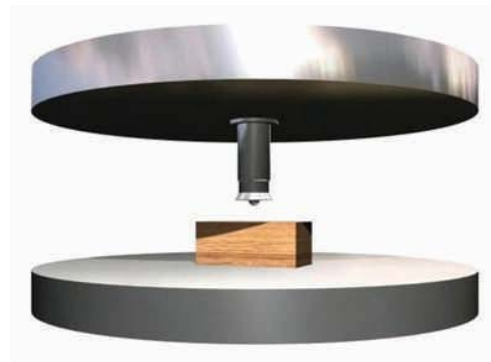
Figura 1 - 41: Esquema de ensayo de dureza. Puede medirse en forma normal o paralela a la fibra.
