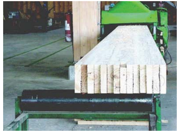
Figura 1 - 93: Unidas las diferentes piezas por las caras, se somete al cepillado lateral.
