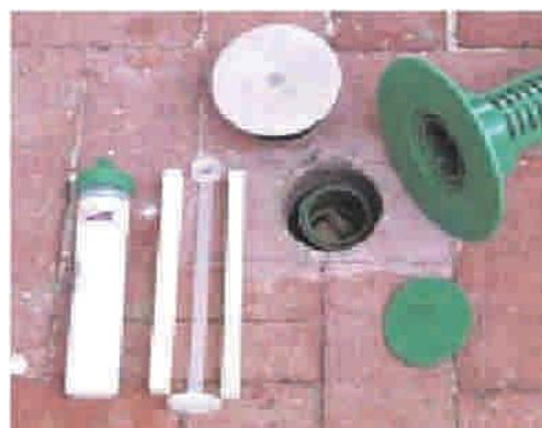
Figura 2 - 18: Tubos de plástico en cuyo interior se ubican los cebos. Por las ranuras ingresan y salen las termitas con la alimentación, bajo tierra, ya que el tubo se entierra en forma vertical hasta el anillo superior, por donde se registra.
