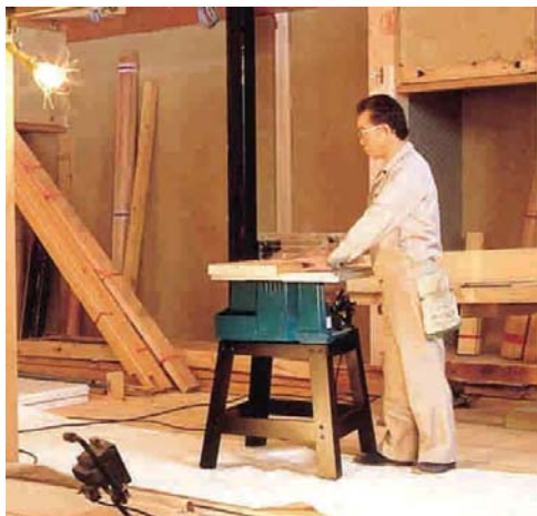
Figura 5 - 46 : Sierra circular para cortes rectos.
