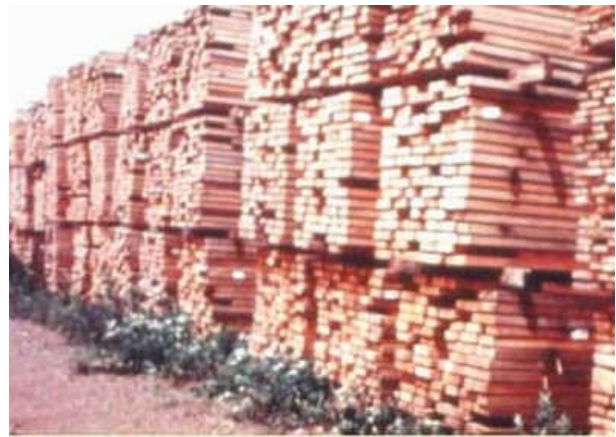
Figura 1 - 59: El adecuado almacenamiento previene los defectos del secado de la madera.
