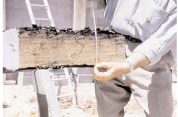
Figura 1 - 100: Resultado del ensayo a la resistencia al fuego.
