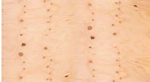
Figura 1 - 82: Tablero contrachapado con grados de cara C/D para fines estructurales o soportantes, en elementos horizontales, inclinados y verticales de construcción.
