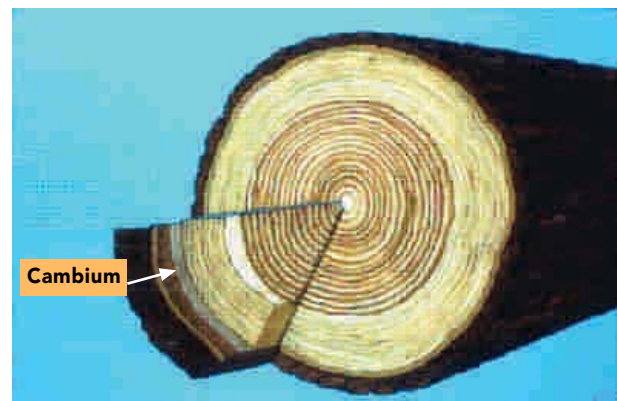
Figura 1 - 6: En la sección transversal del tronco se muestra el cambium o cambio, que se encuentra adyacente al xilema y hacia la corteza.
