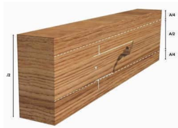
Figura 1- 49: Medición de bolsillo de corteza y/o resina en la zona central de la pieza.
