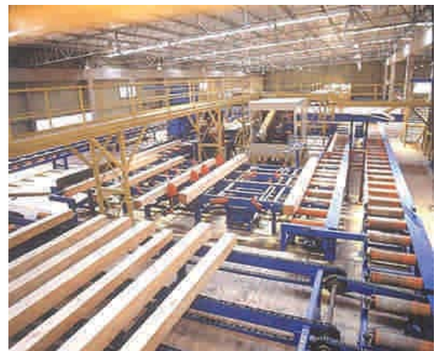
Foto 1 - 16: Aserradero automatizado donde la madera es dimensionada.
