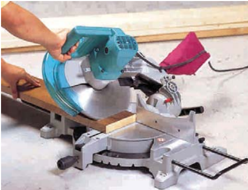
Figura 5 - 45 : Sierra de inglete. Permite cortes en distintos ángulos en el ancho y en el espesor de la pieza.
