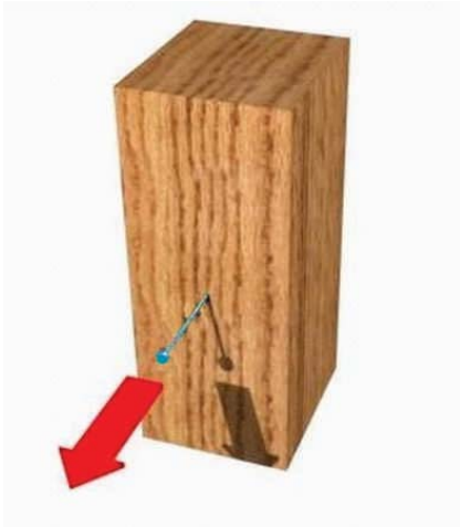
Figura 1 - 42: Esquema de ensayo de extracción de clavo.
