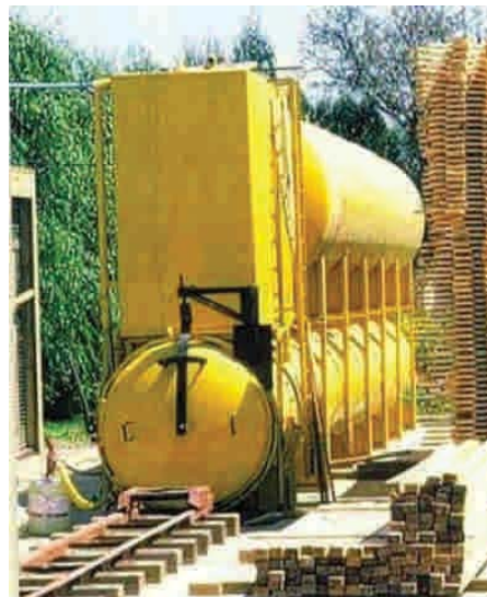
Figura 2 - 21: Planta de tratamiento mediante vacío/presión.
