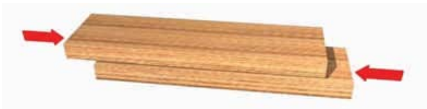
Figura 1 - 33: Esquema de ensayo de cizalle longitudinal.
