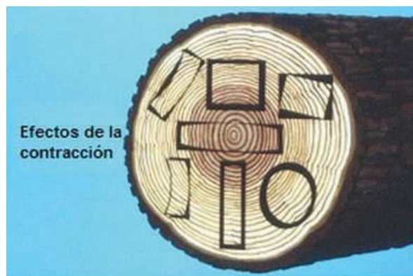
Figura 1-28: Efectos de la contracción en la madera.
