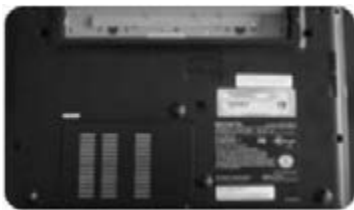
Parte posterior Sin Bateria, visión general de Tornillos
